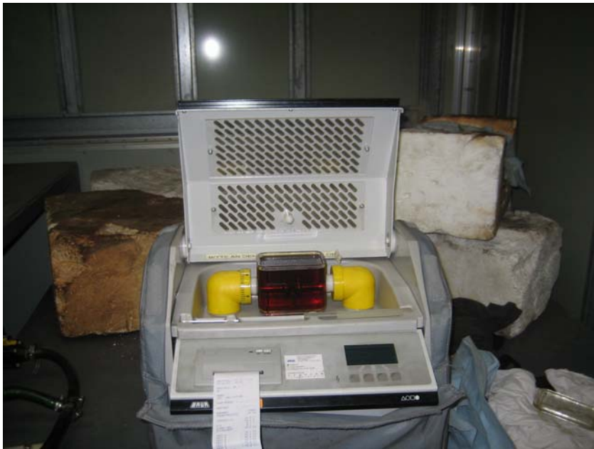
Zdjęcie 32 Pomiar wytrzymałości dielektrycznej oleju
